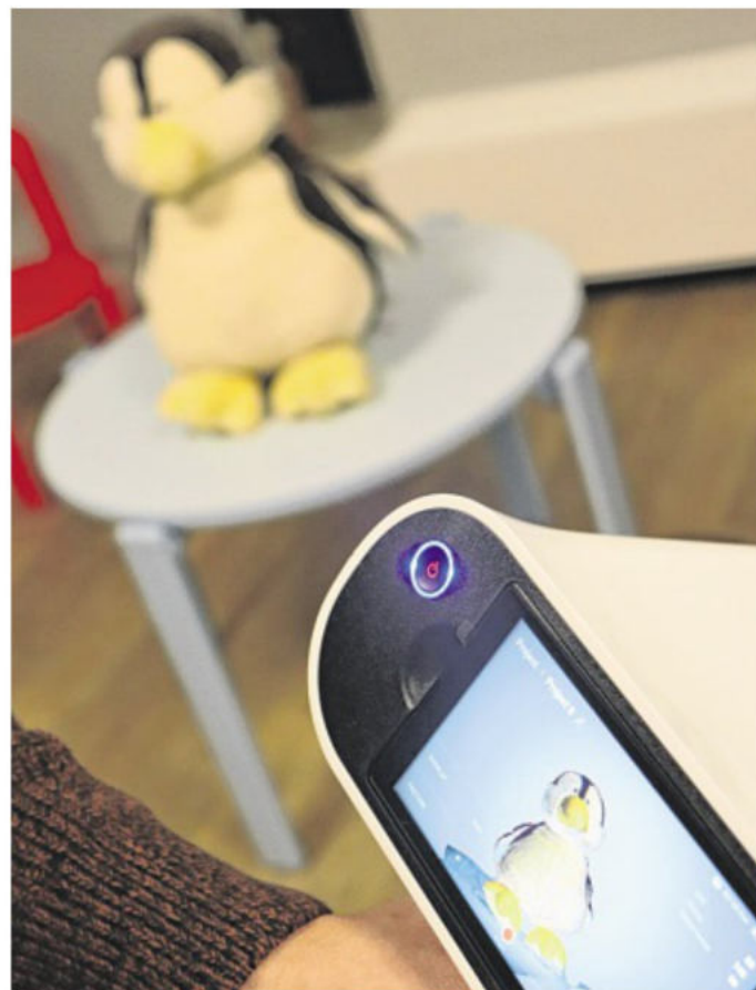
Der kontaktlose 3D-Scanner erstellt ein detailgenaues Bild des Pinguins. Später wird es auf dem Computer noch einmal hochgerechnet. Doch auch auf dem kleinen Bildschirm lässt sich die Beschaffenheit des Stofftiers, das als Beispiel dient, genau erkennen.
